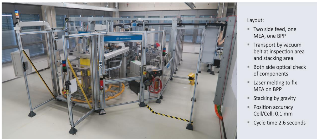
Abbildung 13 Versuchsanlage für die Montage von 30 000 Stacks/Jahr
