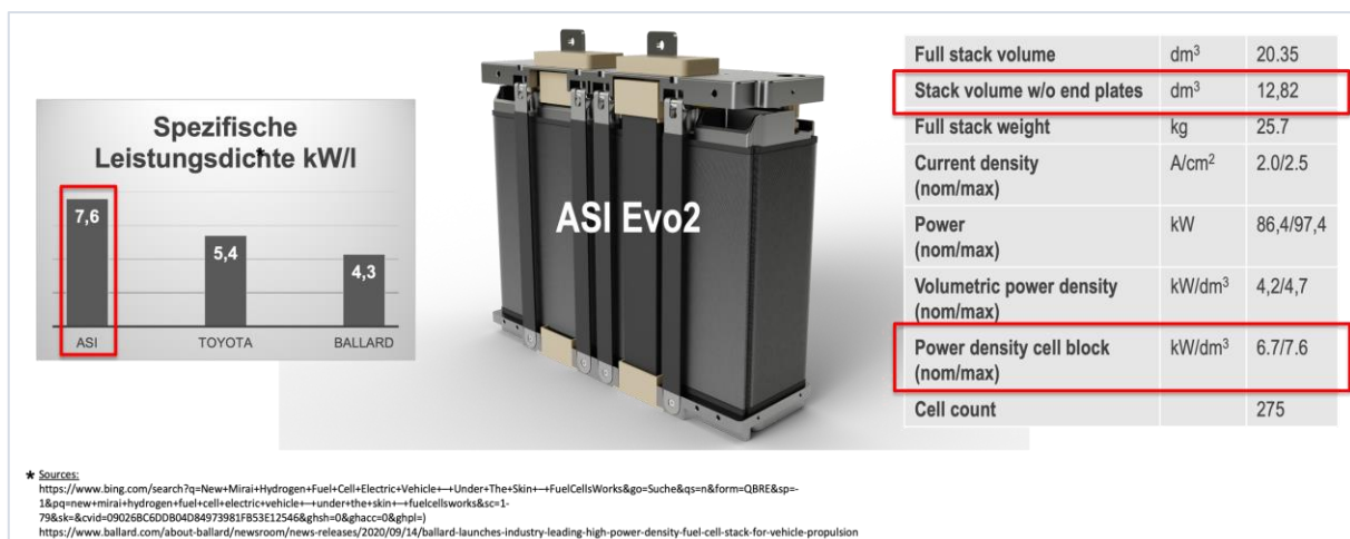
Abbildung 5 Leistungsdichte und Benchmark des Evo2-Designs
